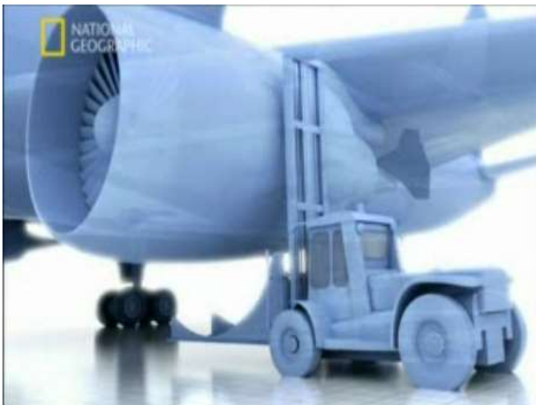
Схема №3. Фактический способ ремонта, отсоединения двигателя от крыла
