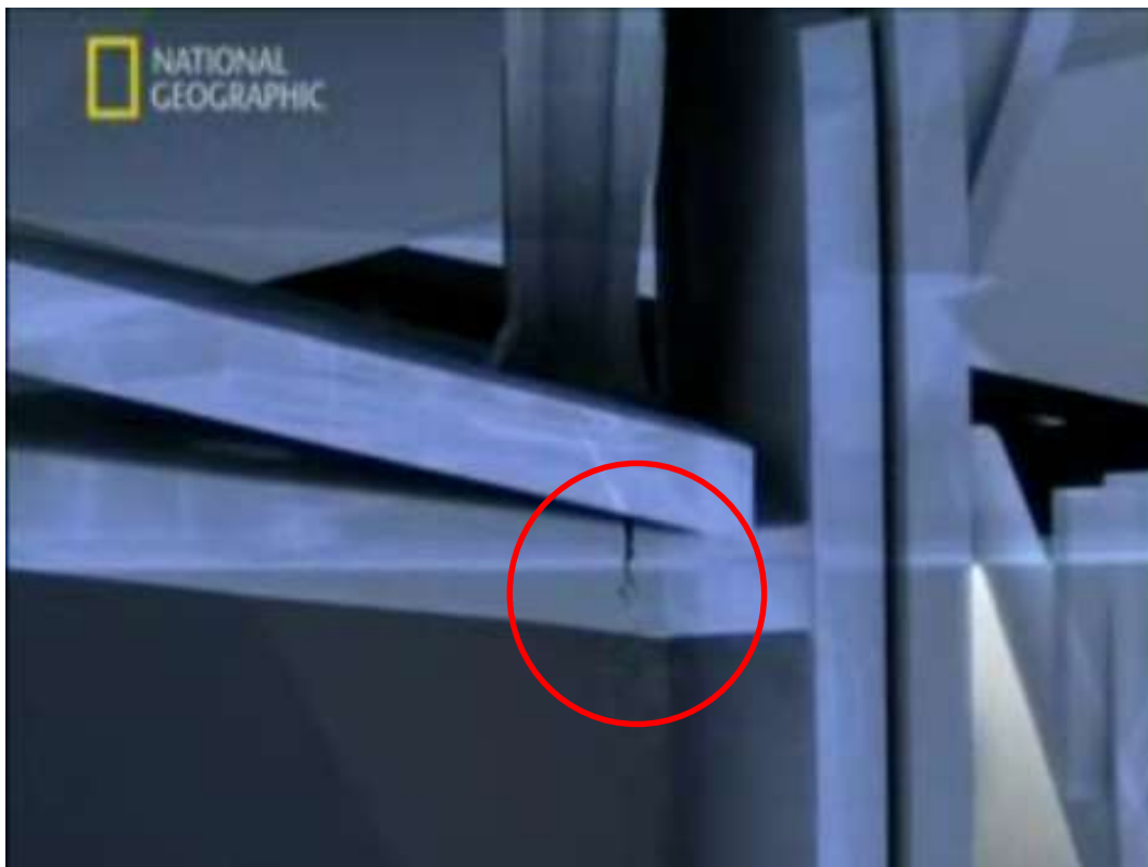
Схема №6. Вид пилона и скобы крыла во время отсоединения, момент образования трещины на пилоне
